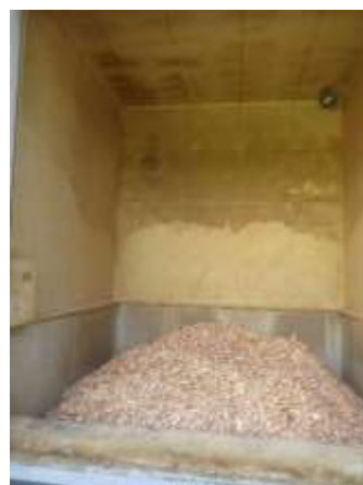
図 3-45 サイロ乾燥システム(左側上部に温風口)
