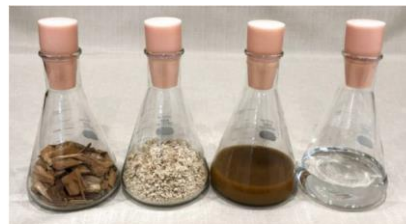
(左から順に) 木材チップ、パルプ、発酵培養液、「森空」バイオエタノール
