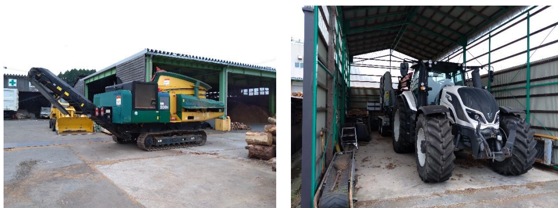
図 9 坂井森林組合の保有するチッパー（左：破碎式、右：切削式）
