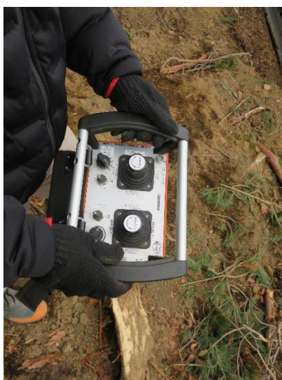
図 4 スキッドのコントローラー
