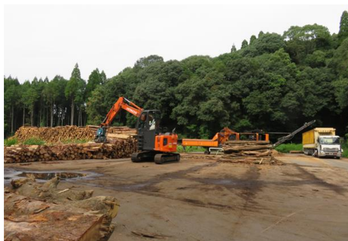
図 23 始良工場の様子 始良工場では移動式（牽引式）チッパーが稼働
