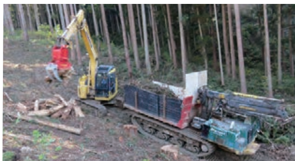
フォワーダで枝条を集積、先山ではグラップルが枝条整理と積み込みを行います。(グラップル1名、フォワーダ1名、計2名)
