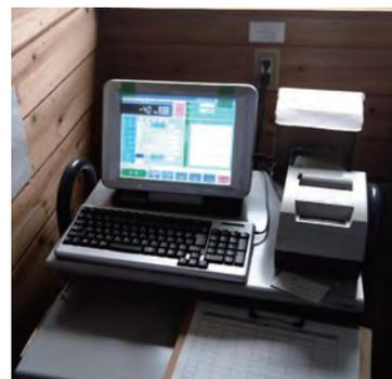
トラックスケールの端末は森林組合内に設置されています。このトラックスケールの計測データにより森林組合と日本フォレスト間で木材が取引されます。
