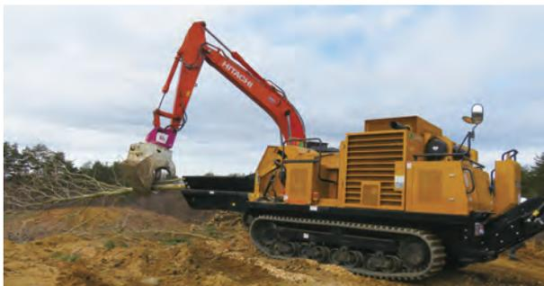
全木のままチッパーに投入します。横入れ式切削チッパーにより、20分程度で約10m<sup>3</sup>のコンテナが満載となります。
