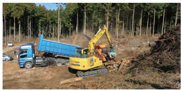
チップ化の際、チップはチップパーから直接トラックの荷台へ吹き込むことで効率化を図っています。少人数で作業ができるよう、グラブオペレーターがチップパーをリモコンで操作します。
