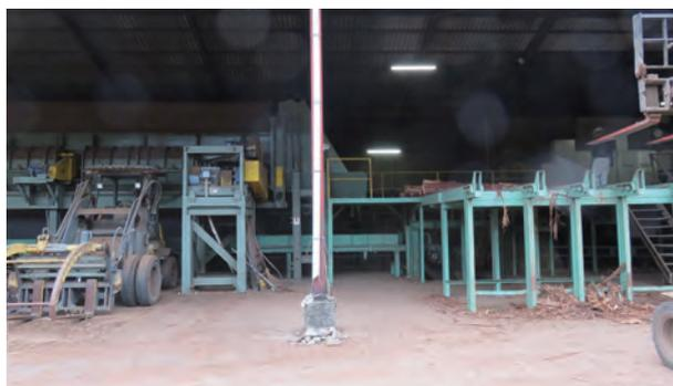
県内に3か所工場を保有しており、エネルギー用だけでなく製紙用のチップも生産しています。写真は固定式のチッパーです。
