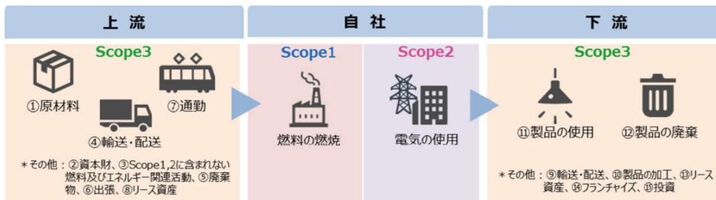
**Scope1** : 事業者自らによる温室効果ガスの直接排出(燃料の燃焼、工業プロセス)
