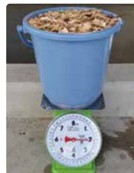
バケツを使った水分の簡易測定
