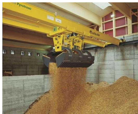
図6.15完全自動クレーン・システムは、アンロード・トラフと日常サイロ (出典: Schmid ENERGY Solutions)
