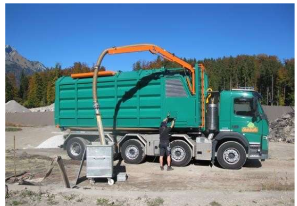
図14.8 灰抽出システムを搭載した輸送車両 (出典: Holzenergie Schweiz)
