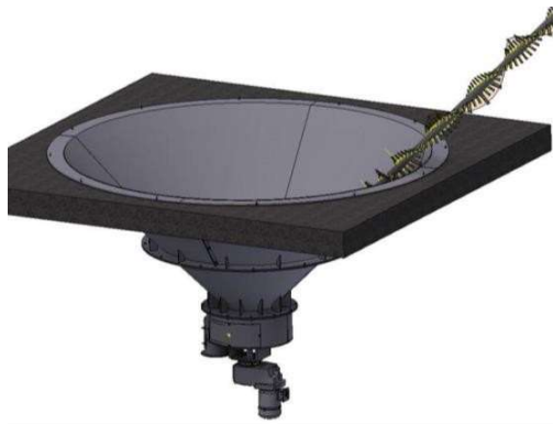
図6.24 円錐スクリーンによる排出システム(出展: Schmid ENERGY Solutions)
