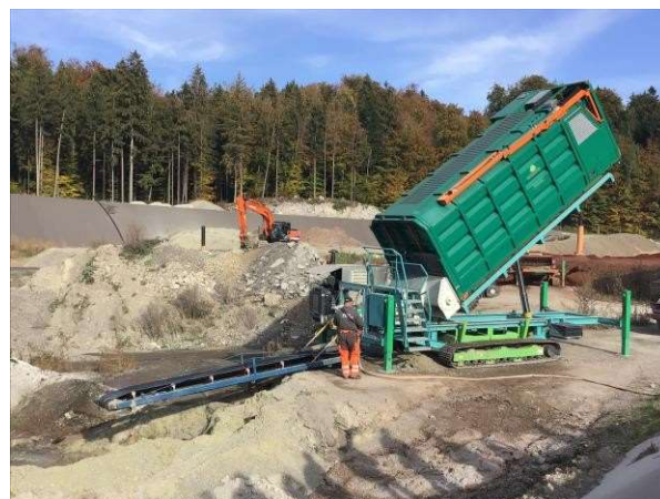
図9.2木質灰をごみ埋立地に埃のない形で堆積（出典：Amstutz Holzenergie AG/Holzenergie Schweiz)
