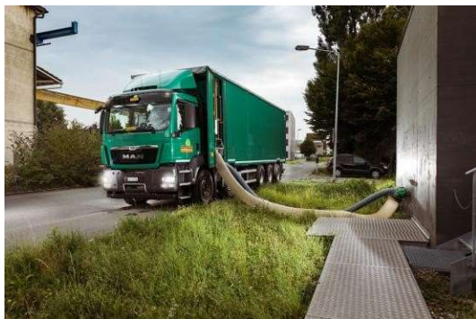
図6.14 のポンプサイロ(出展: Amstutz Holzenergie AG)
