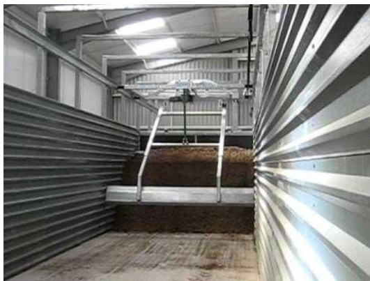
図6.18 トップローダー(出展: Vecoplan AG)
