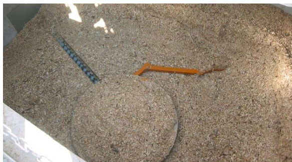
図6.27 高品質の木材チップおよびペレット用の関節アームを備えた排出システムです(出典: Holz-Energie Schweizなど)
