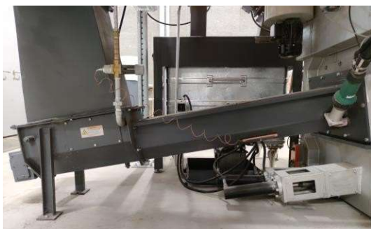
図6.35 スクリューコンベアを使用してフィード(出展: Schmid ENERGY Solutions)
