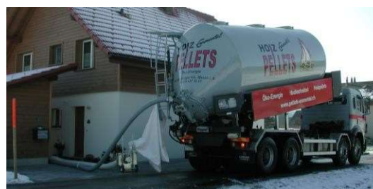
図6.20吸着ファンとダストバッグを使用したペレットの供給(出典: Holzenergie Schweiz)
