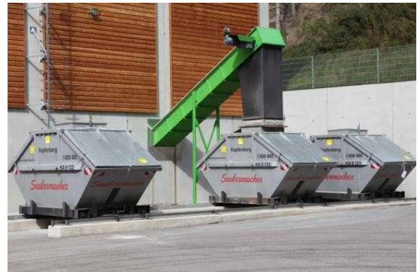
図14.7 灰トラフ交換装置 (出典: AEE INTEC)。
