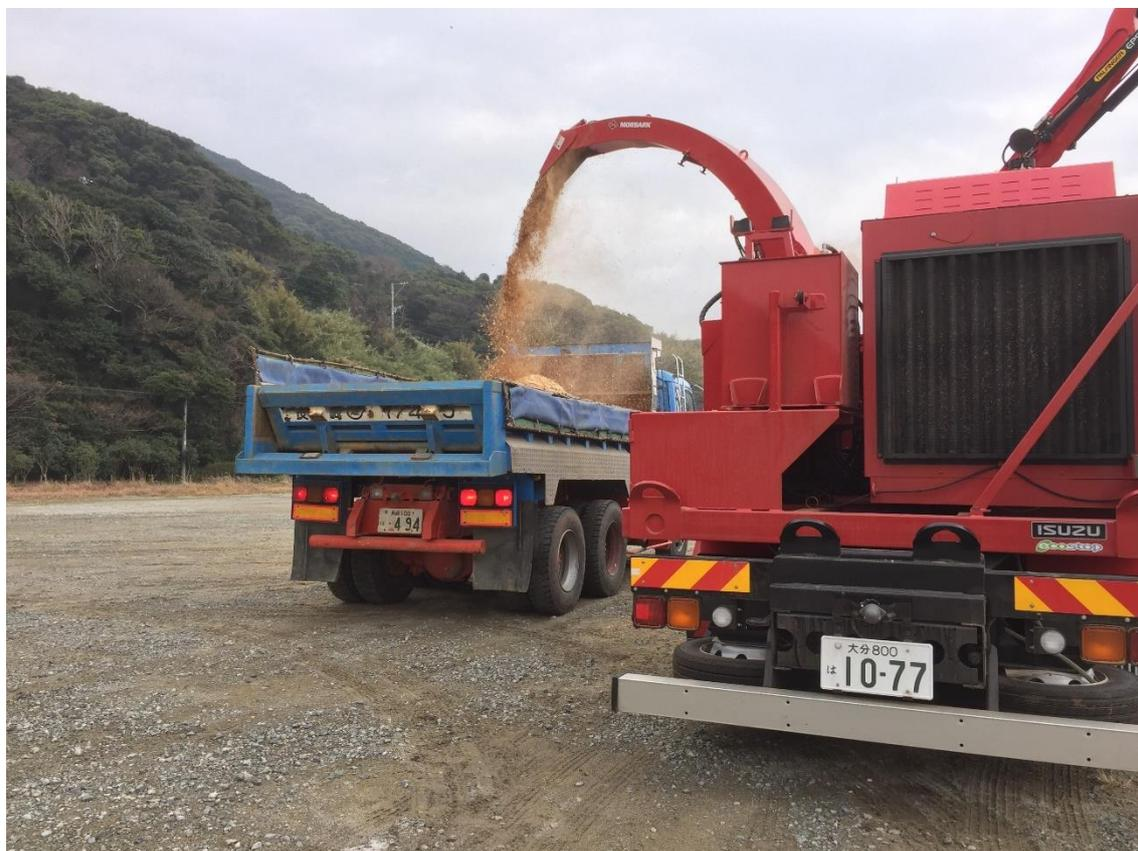
図 29 移動式チッパーからトラックに直接チップを吹き込む様子
