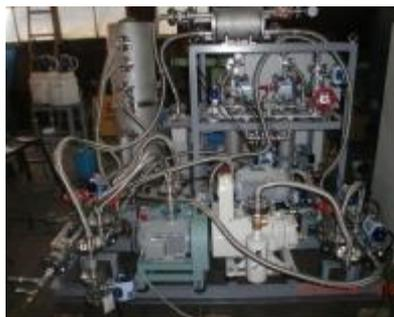
圧力変動吸着装置
