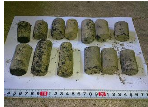
試験的に、備長炭窯でも炭化したところ すべて0~0.5内(精錬度)
