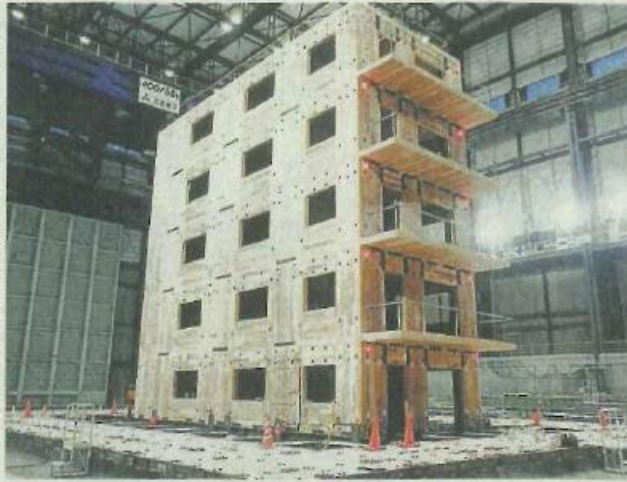
実大三次元震動破壊実験施設（Eーティフ エン）で実施されたCLT5階建ての震動実験。2015年2月、三木市志染町（日本CLT協会提供）
