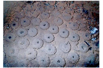
熱交換器内部(試験後)
