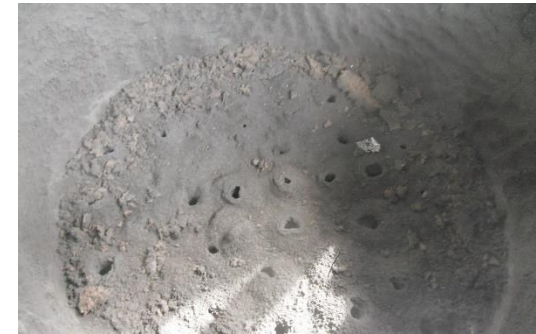
堆積物による圧力損失増大
