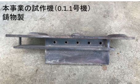
図：鋳物試作した「バーナー口(使用期間2.5月)」
